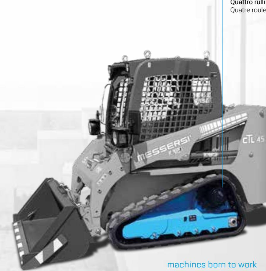
Quattro ruoli per cingolo a forma conica maggiorati per il CTL45.
