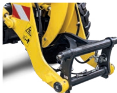
Attacco rapido attuato elettricamente per un facile e veloce cambio degli accessori
