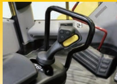
Sistema sterzante avanzato con joystick (Advanced Joystick Steering System)
