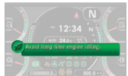
La guida Eco contribuisce al risparmio di energia in tempo reale (ad esempio, evitando lunghi periodi di inattività del motore)
