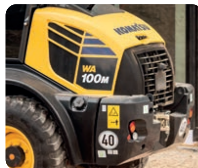
Velocità trasmissione idrostatica limitata a 40 km/h (optional)
