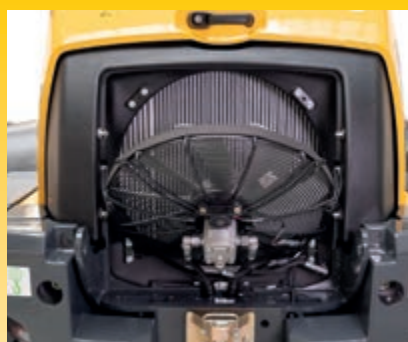
La ventola radiatore inclinabile facilita l'accesso per la pulizia
