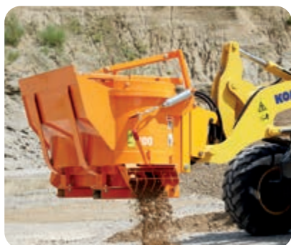
Versione High flow con portata max. di 120 l/min a 210 bar (optional)
