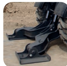
Cilindri lama/stabilizzatori con valvola di ritegno integrata (di serie)
