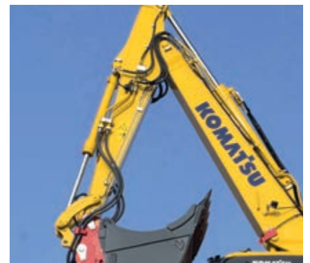
Nuova configurazione delle linee HCU con design unico per tutte le lunghezze di avambraccio
