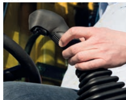
Per sterzate frequenti, il sistema opzionale "Joystick di sterzo" permette di controllare la macchina con meno sforzo
