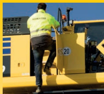
Scala dritta di accesso per la manutenzione, corrimano e piastre antisdrucchio
