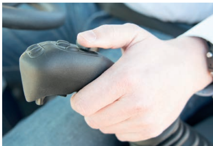
Per sterzate frequenti, il sistema opzionale "Joystick di sterzo" permette di controllare la macchina con meno sforzo
