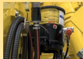
Sistema d'ingrassaggio centralizzato (optional)
