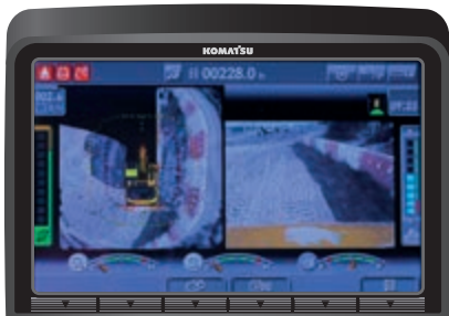
Grazie a KomVision, sono disponibili varie viste opzionali con la telecamera, pur mantenendo sempre una "visione dall'alto" della macchina
