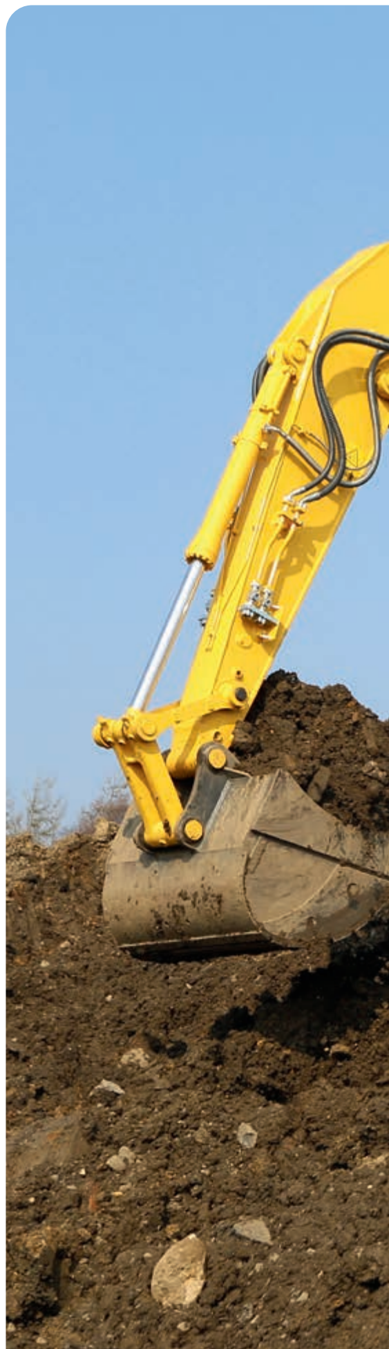
Due linee idrauliche opzionali per montare una serie di accessori
