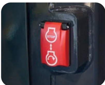
Interruttore secondario di arresto motore
