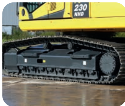
Sottocarro stretto per impieghi gravosi e struttura superiore stretta
