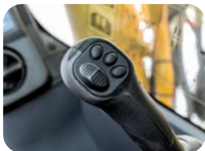
Comandi comodi, ergonomici e precisi: manipolatori con pulsante di comando proporzionale per gli accessori
