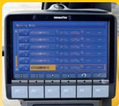
Komatsu Integrated Attachment Control (KIAC) con fino a 15 valori preimpostati per portata e pressione olio (optional)
