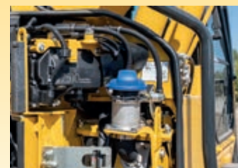
Per semplificare l'accesso, il serbatoio AdBlue® è installato vicino alla scala anteriore.
