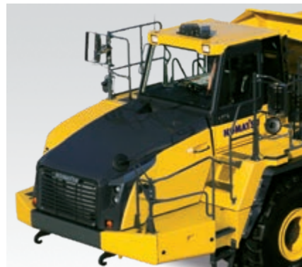
Sistema ROPS/FOPS integrato conforme alle norme ISO 3471 e SAE J1040-1988c
