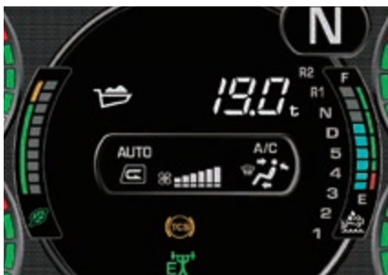
La bilancia di pesatura del carico utile visualizza il peso a pieno carico
