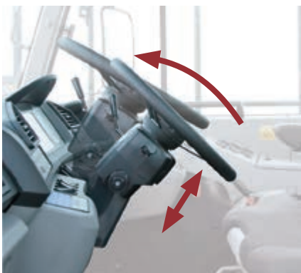
Disposizione del volante nella posizione più comoda
