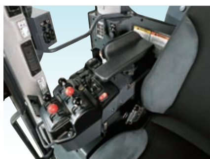
L'altezza della console integrata nel bracciolo è regolabile elettricamente
