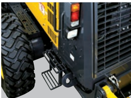
Scalini rigati e pedana in metallo perforato per un accesso sicuro
