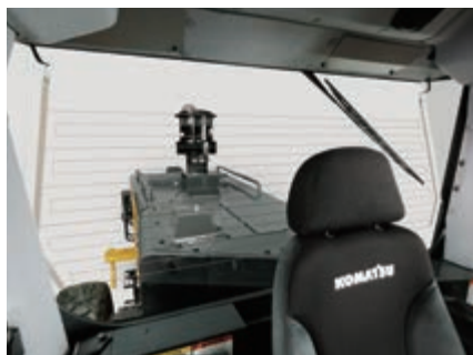
Il cofano motore basso e stretto garantisce una perfetta visibilità nella zona posteriore
