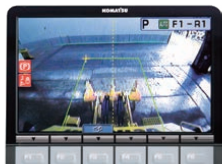
Sistema di telecamera posteriore completamente integrata
