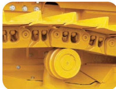
Le singole maglie possono essere sostituite utilizzando normali attrezzi per cingoli
