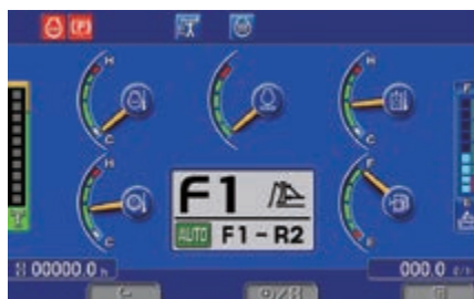
Modalità cambio automatico per ottimizzare ulteriormente il consumo di carburante
