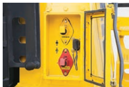
Scatola di sezionamento per batteria e motorino di avviamento (optional sulle macchine per attività estrattive) con presa per avviamento con cavi.
