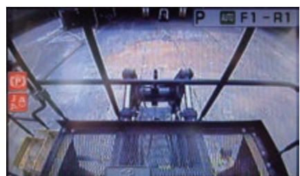
Sistema di telecamera posteriore completamente integrata
